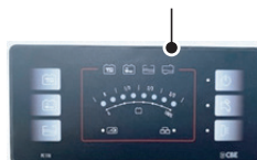
Voyant du réservoir des eaux usées
