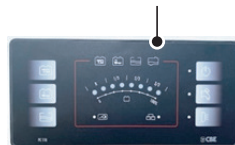
Piloto del depósito de aguas residuales
